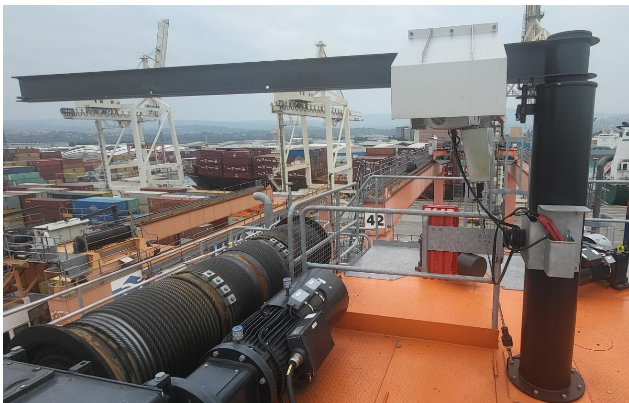
Slika 3: Obstoječe servisno dvigalo na RTG dvigalu
