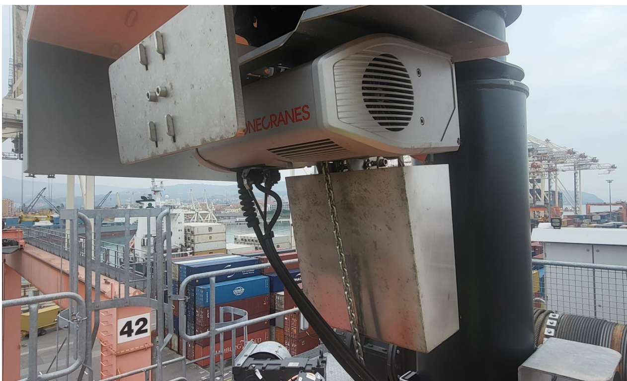
Slika 4: Obstoječe servisno dvigalo na RTG dvigalu
